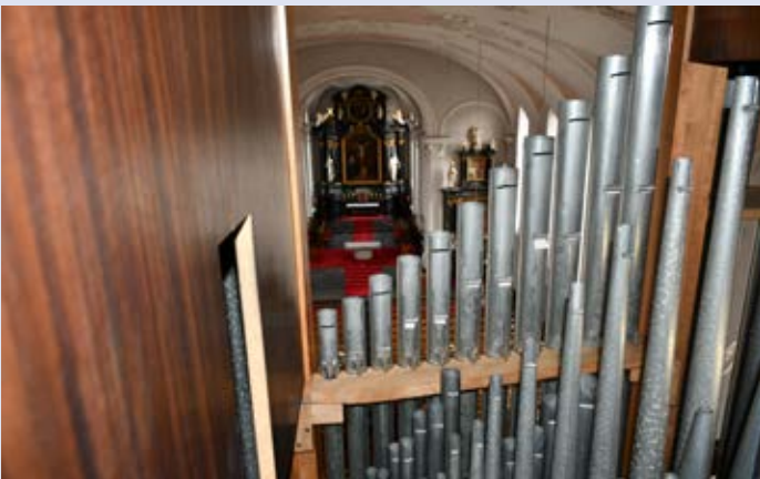
Hier sieht man gut die sogenannten Stimmwirbel auf der Rückseite der Pfeifen. Mit ihnen kann die Tonhöhe beeinflusst werden.
